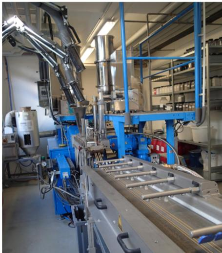
Die Flexibilität der Anlage ist durch die Aufrüstung im letzten Jahr weiter gestiegen, so verfügt der Extruder über drei Dosiereinheiten. Das Matrixpolymer, die Additive, Füll- und Verstärkungsstoffe lassen sich über den Haupteinzug oder zwei Sidefeeder an unterschiedlichen Stellen des Verfahrenswegs einbringen. Es besteht an zwei atmosphärischen und einer Vakuumentgasung die Möglichkeit flüchtige Stoffe aus dem System zu entfernen.
